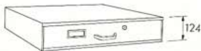
2/5 Låsbar låda. Rosengrens lås typ F 6 Inv. dim: h = 87, b = 474, d = 355 mm
